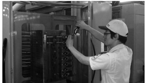
▲導入されたH.Plus-405では、デジラチェ「メモルク」を使ってワーク取付けを実施しています
