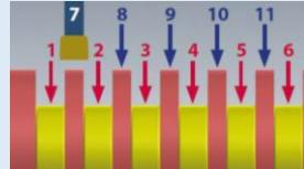
リブ切削プランジの加工シミュレーション
