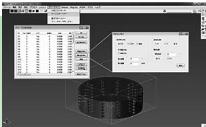
▲4軸の穴と5軸の穴の回転加工
