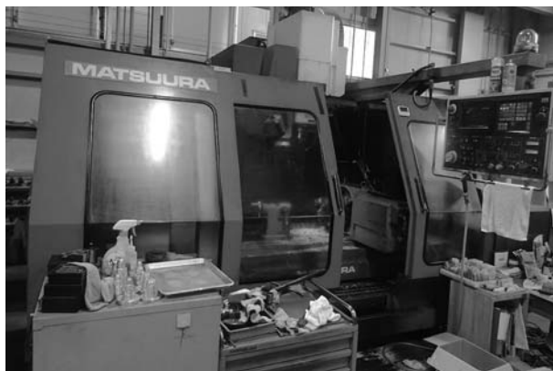
▲A軸テーブルが付加したMC-800V
