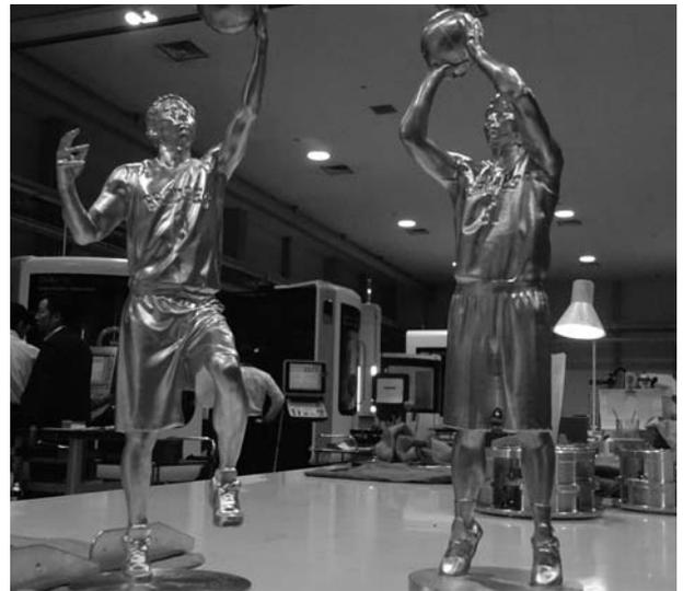
▲5軸加工機で作成されたトロフィー
