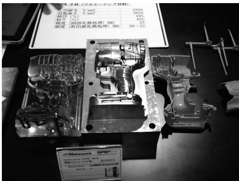
▲電動ドライバーの金型と成形品
