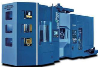
本製品は、1991年以来、世界の様々な産業に導入され、累計出荷1700台以上の実績を持つ5軸制御マシニングセンタ**MAM72**シリーズの小型、中型ワークを対象とした最新モデル。従来機に比べ最大工作物寸法を拡大した上で、性能を徹底的に見直し、生産性・作業性を高めたことで、より高いお客様ニーズを満たしています。
