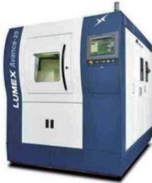
本製品は、積層した金属粉末をレーザー照射で焼結する「金属光造形」、エンドミルによる「高速・高精度切削」、これらを繰り返しワンマシン・ワンプロセスで造形を行います。このハイブリッド技術により、従来の3D金属プリンタでは得られなかった、マシニングセンタと同等の高い加工精度、面粗度を実現しています。
