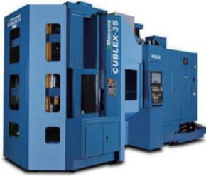
本製品は、1991年以来、累計出荷1700台以上の実績を持つ5軸制御マシニングセンタ **MAM72** シリーズの **MAM72-35V** をベースに旋削機能を付加した5軸複合マシニングセンタ。多品種少量生産・長時間無人運転を得意とし、付加された旋削機能により、工程集約の適応範囲が大きく拡がり、高精度加工と生産性向上を実現します。
