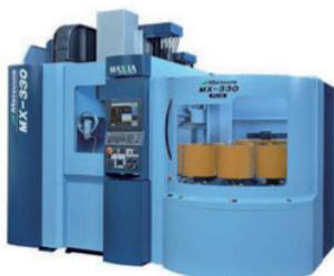
本製品は、「はじめてでも安心・簡単な5軸機」をキーワードに、良好な操作性・高い加工能力・コストパフォーマンスを有した**MX**シリーズ3機種中、小型ワークを対象としたモデル。省スペース&リーズナブルプライスで長時間無人運転可能な点が、市場ニーズにマッチしており、当社のベストセラーモデルとなっています。
