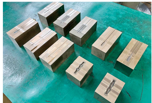
▲マツウラ機で加工された眼鏡部品の金型
