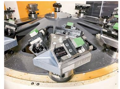
▲ 工具鋼の加工に用いる3面イケール
