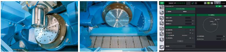
▲ C軸にDDモーター採用 ▲ 優れた切粉排出構造 ▲ 複合加工対応**MiOS 4**搭載
