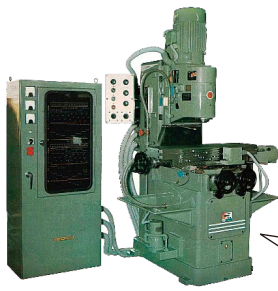
SB-1型 前後・左右・上下の3方向に0.02mm以内に精密停止が出来るプロコン
