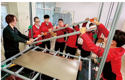
▲ 組立本部守谷さん(左)と科学技術高校電子電気科6名 3Dプリンタのフレームを組み立てている様子
