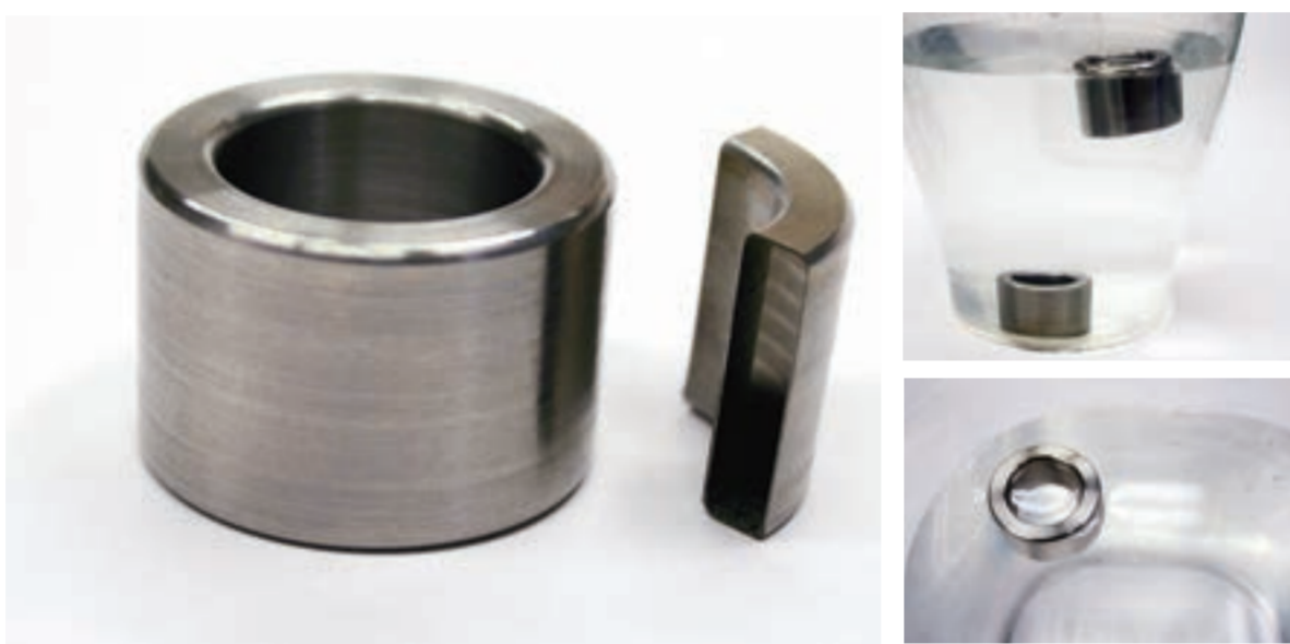
水に浮く鉄輪（造形及び切削加工の複合技術） 43時間 / 7個 + 旋削
